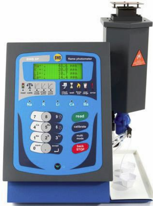
الشكل (5): تقدير عنصري الصوديوم والبوتاسيوم في عينات الماء وذلك بواسطة جهاز مطياف اللهب من صنع شركة BWB البريطانية .
