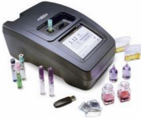
الشكل (4): يوضح جهاز السبيكتروفوتوميتر المستخدم في قياس تركيز العناصر
